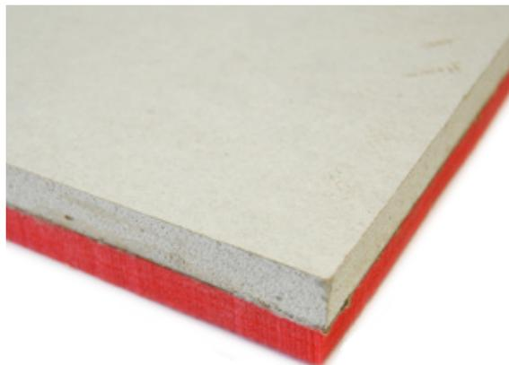
Prodotto composto da una lastra di gesso rivestito (spessore 12,5 mm) accoppiata ad uno strato di Isolmant Special (spessore 10 mm). Per il risanamento acustico e termico delle pareti.
