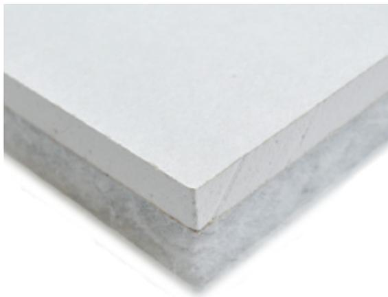
Prodotto composto da una lastra di gesso rivestito (spessore 12,5 mm) accoppiata ad un pannello di IsolFIBTEC PFT (fibra riciclata in tessile tecnico a densità crescente lungo lo spessore, dalle elevate prestazioni acustiche e termiche) di spessore 20 mm.
