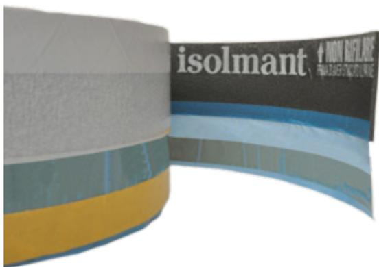
Fasce perimetrali adesive predisposte per una posa facilitata ad "L", composte da una parte verticale in polietilene espanso reticolato sp. 5 mm parzialmente adesiva da applicare a parete e da una parte orizzontale in film HDPE di spessore ridotto di 0,1 mm dotata di carta siliconata adesiva sul lato inferiore. Le fasce sono dotate di filmatura serigrafata con le istruzioni di posa.
