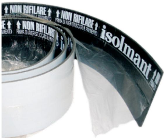
Fasce verticali in polietilene reticolato espanso a celle chiuse con adesivo "stacca e attacca" da 15 cm di altezza in Isolmant 8 mm dotate di serigrafia con istruzioni di posa e velo di polietilene per il sormonto sul pannello radiante. Specifica per l'utilizzo con Isolmant Radiante.
