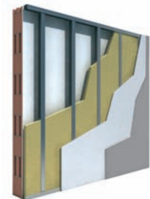
Controparete ad orditura metallica autoportante
