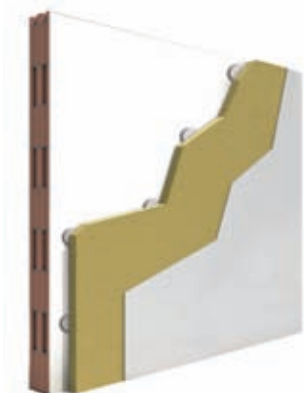
Controparete con Isolastra incollata alla muratura esistente
